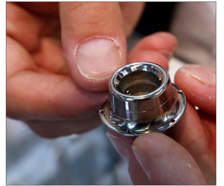
■ Fabriquée par les décolleteurs d'Ornans, cette « chambre » implantée sur le patient, qui diffuse la chimiothérapie.
